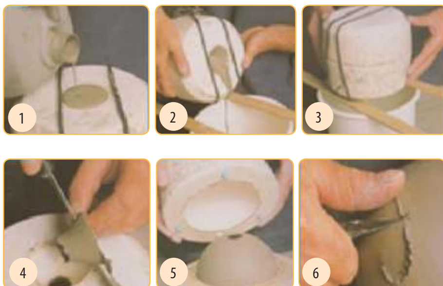
Gambar 1.18. Proses cetak basah dengan teknik cor.
