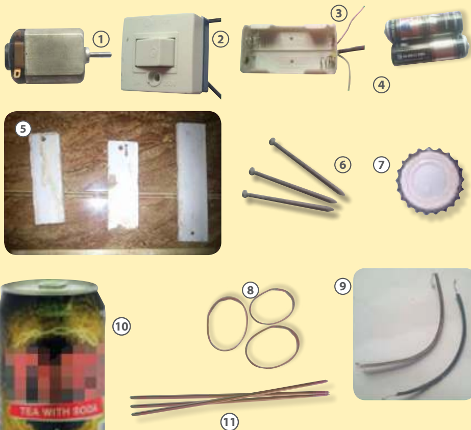
Gambar 2.24. Bahan Bel Sederhana; 1) Motor Listrik DC 3 Volt, 2) Saklar, 3) Tempat Baterai, 4) Baterai 1,5 Volt 2 Buah, 5) Kayu, 6) Paku, 7) Tutup botol, 8) Karet, 9) Kabel, 10) Kaleng, 11) Lidi.
