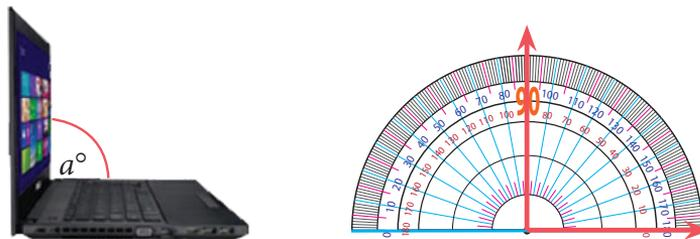
**Gambar 7.24 :** Cara Mengukur Sudut Menggunakan Busur Derajat
