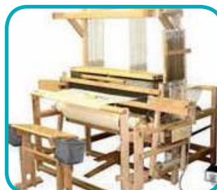
Alat tenun ATBM (Alat Tenun Bukan Mesin) untuk tenik tenun pada serat
