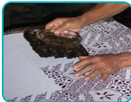
Gambar 2.33 Teknik cap pada proses pembuatan batik.
