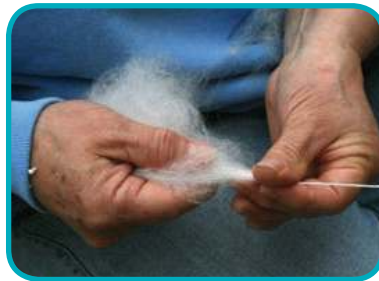
Gambar 1.18 Pemintalan kapas menjadi benang secara manual.
