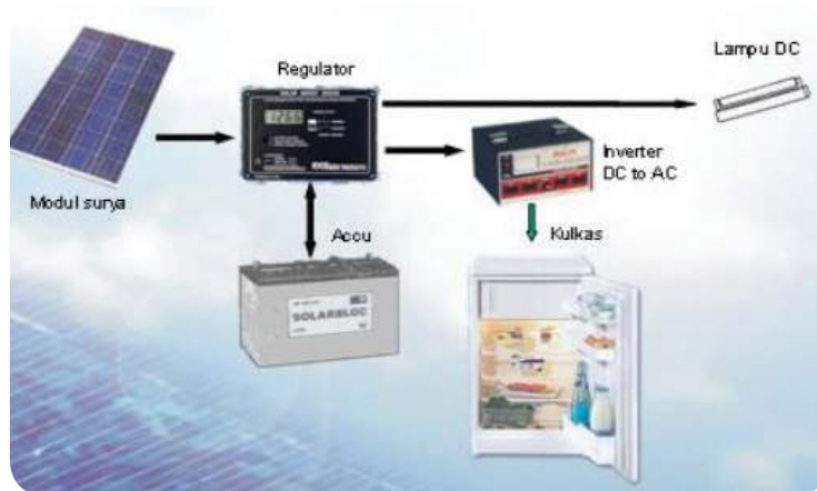
Gambar 2.5 Komponen konversi energi surya menjadi energy listrik
