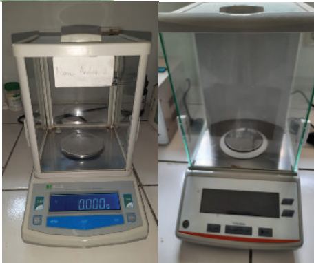
Gambar 4.32 Neraca analitik digital dengan ketelitian 0,1 mg dan 1 mg. Sumber: Wagiyono/2022
