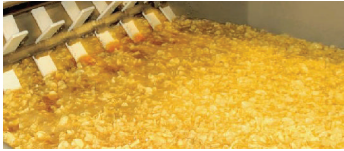
Gambar 5.3 Pindah panas konveksi pada proses penggorengan keripik kentang. Sumber: heatandcontrol.com/2017
