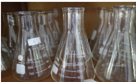
Gambar 4.4 Salah satu kegunaan labu Erlenmeyer untuk tempat mereaksikan zat. Sumber: Wagiyono/2021
