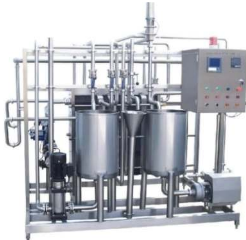
Gambar 6.24 Alat Pasteurisasi Sumber: Wiji Ramesya(2020)
