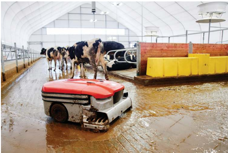
Gambar 2.11 Pembersihan kandang oleh mesin robot Sumber: Shutterstock_1718735422
