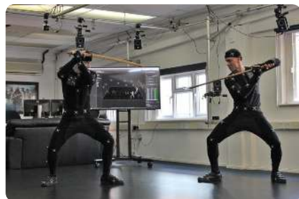
Gambar 2.27 Ilustrasi penangkapan gerak pada teknik motion capture Sumber: vicon/cgicoffee.com (2018)
