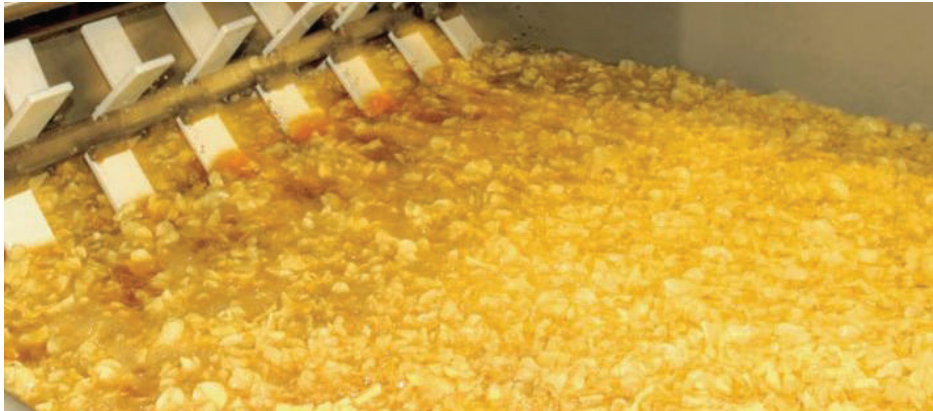
Gambar 4.10 Pindah panas konveksi pada proses penggorengan keripik kentang. Sumber: heatandcontrol.com/2017
