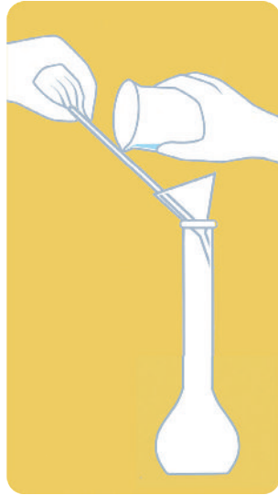
Gambar 6.11 Sketsa teknik penuangan cairan. Sumber: Wagiyono dan Ade/2022
