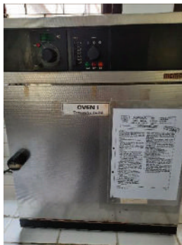
Gambar 6.7 Oven untuk sterilisasi udara panas. Sumber: Wagiyono/2022
