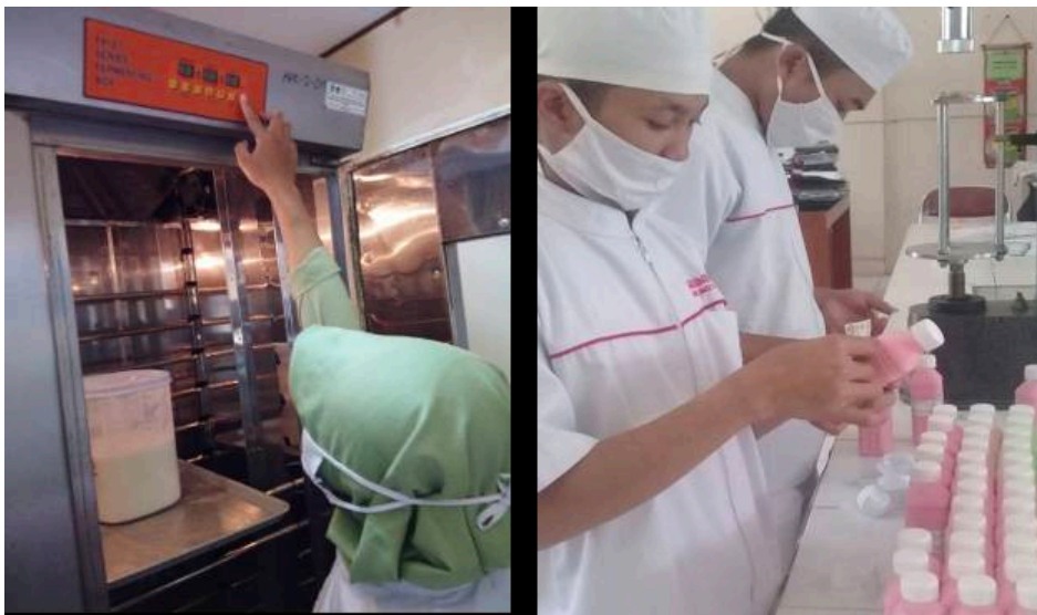
Gambar 4.25 Proses fermentasi susu (yoghurt) menggunakan fermentor. Sumber: Mohamad Fadholi/2017
