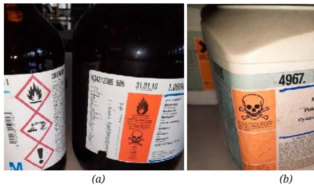
Gambar 6.3 Simbol/gambar pada label kemasan bahan kimia (a) cair (b) padat Sumber: Wagiono (2022)
