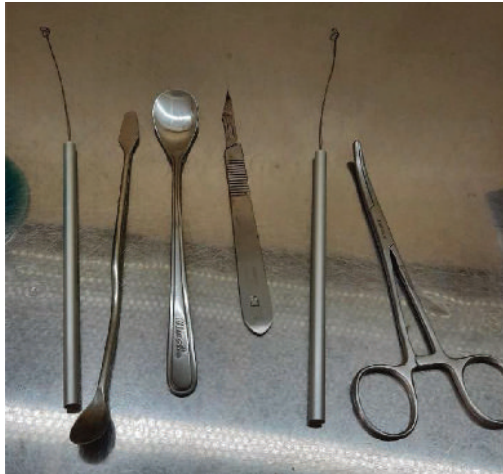
Gambar 6.6 Peralatan yang biasa disterilisasi pemijaran. Sumber: Wagiyono/2022
