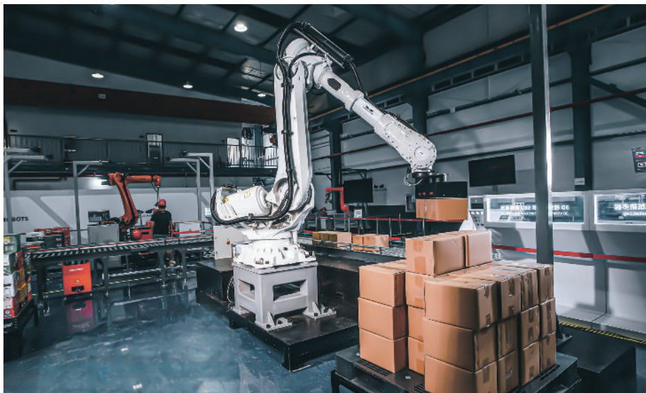
Gambar 2.3 Robotisasi dalam proses pengemasan. Sumber: unplash.com/Mech Mind/2021
