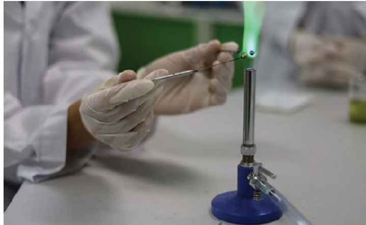
Gambar 6.4 Proses sterilisasi alat (ose) dengan pemijaran sebelum digunakan untuk pemindahan kultur mikroba Sumber: syaf.co.id/2022
