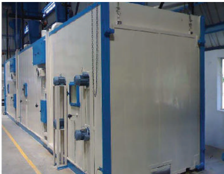
Gambar 4.16 Mesin pengering terowongan ( tunnel dryer ). Sumber: kerone.net
