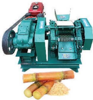
Gambar 1.8 Mesin penghancur batang tebu ( sugar cane crusher ).
