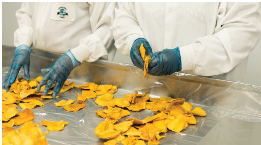
Gambar 2.4 Salah satu penggunaan APD (sarung tangan) untuk higiene personal dalam industri makanan.
