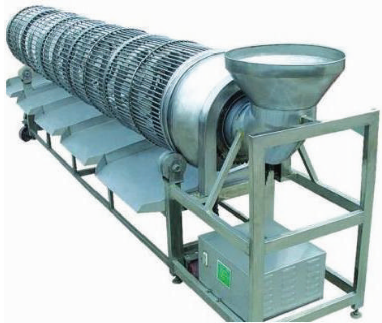
Gambar 1.5 Mesin sorting ( screen ) untuk buah-buahan. Sumber: wsfoodmachine.en.ecplaza.net/2022
