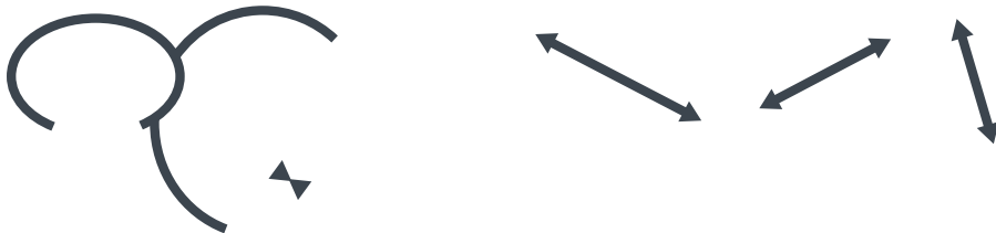
Gambar 1.4 Pola-pola gerakan/getaran ayakan bidang datar. Sumber: Wagiyono dan Eko Fitriano/2022
