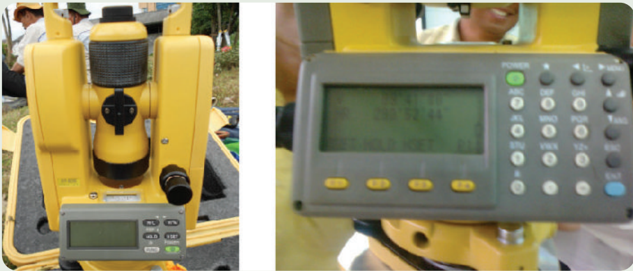
Gambar 2.17 Penggunaan theodolite digital dan Total Station
