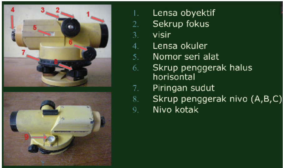
Gambar 3.16 Bagian-bagian dari PPD (Sumber Foto: Tutus Rektono Wahyuningrum, 2006)
