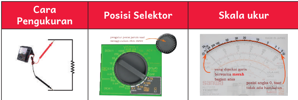
Gambar 4.7 Cara Pengukuran Resistansi Menggunakan Multimeter
