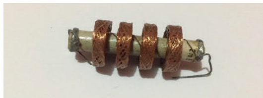
Gambar 2.31 Komponen pada Induktor Jenis Solenoid
