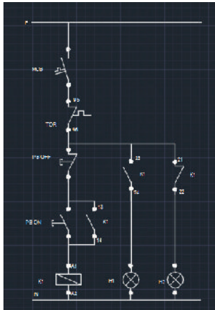
Gambar 5.26 Simbol Komponen yang telah Dihubungkan Garis
