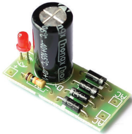
Gambar 2.2 Modul Penyearah pada Catu Daya Sumber: Alibaba.com (t.t.)
