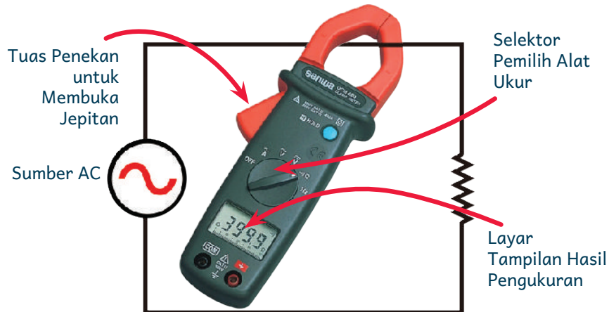
Gambar 4.9 Pemasangan Tang Ampere
