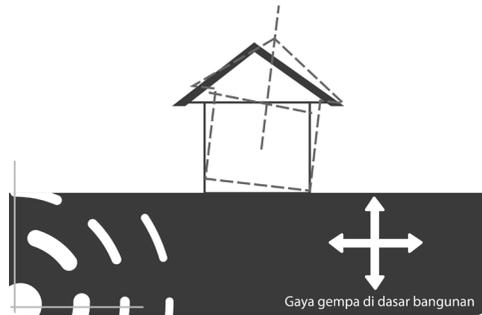
Gambar 5.3 Beban gempa dalam struktur bangunan.
