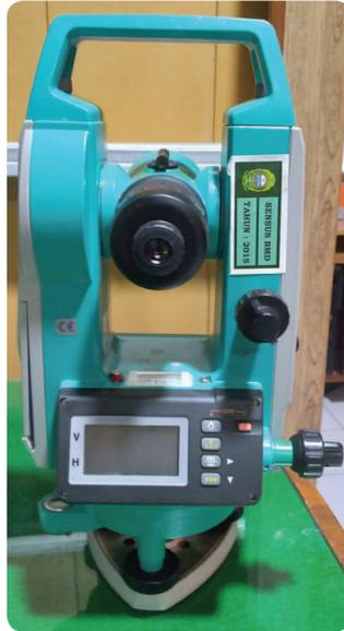
Gambar 4.5 Alat Ukur Sipat Ruang (*Theodolite*)
