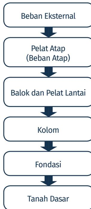
Gambar 5.4 Diagram alur penyaluran beban dalam bangunan.
