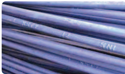
Baja tulangan polos
