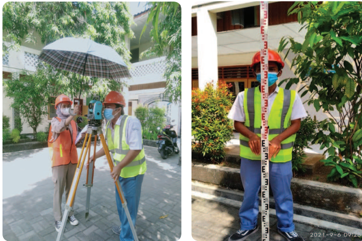
Gambar 4.16 Siswa praktik menggunakan waterpass .
