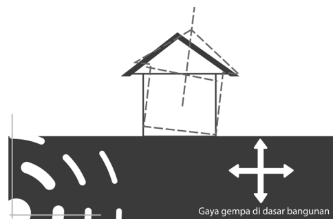
Gambar 5.3 Beban gempa dalam struktur bangunan.
