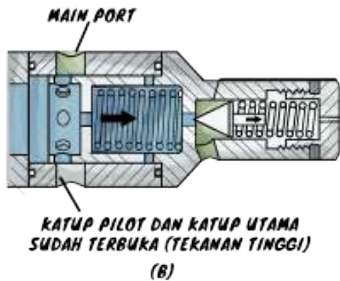
Gambar 5.14 Katup Pengontrol Tipe Pilot
