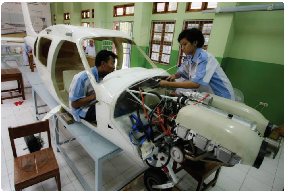
Gambar 2.4 Piston Engine Tipe Opposed Pesawat Jabiru SMKN 29 Jakarta Sumber: ANTARA/M Agung Rajasa (2011)
