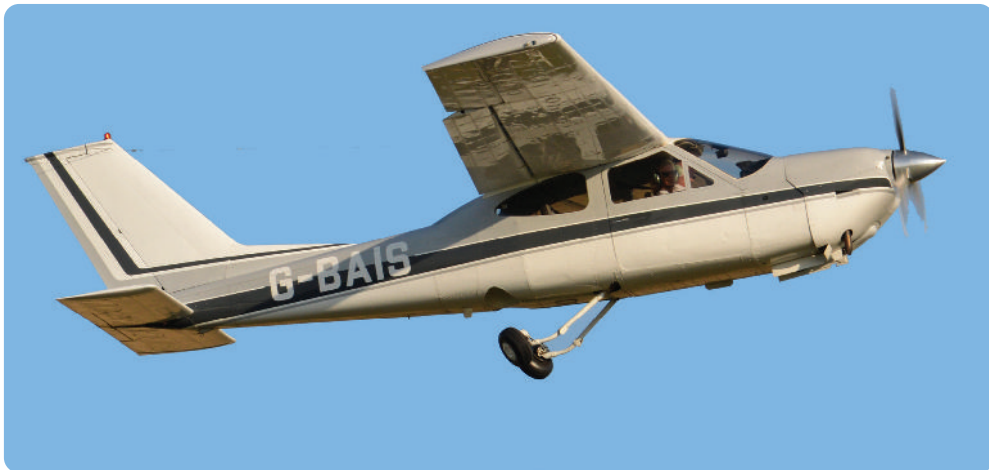
Gambar 1.15 B Rancangan Sayap Tanpa Penyangga Luar ( No External Bracing ) Sumber: wikimedia.org /Alan Wilson (2017)
