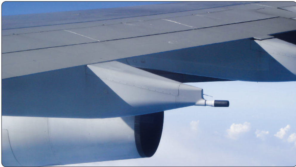
Gambar 4.38 Dump Nozzle Airbus A340-311 Sumber: wikipedia.org/Lahiru K (2007)
