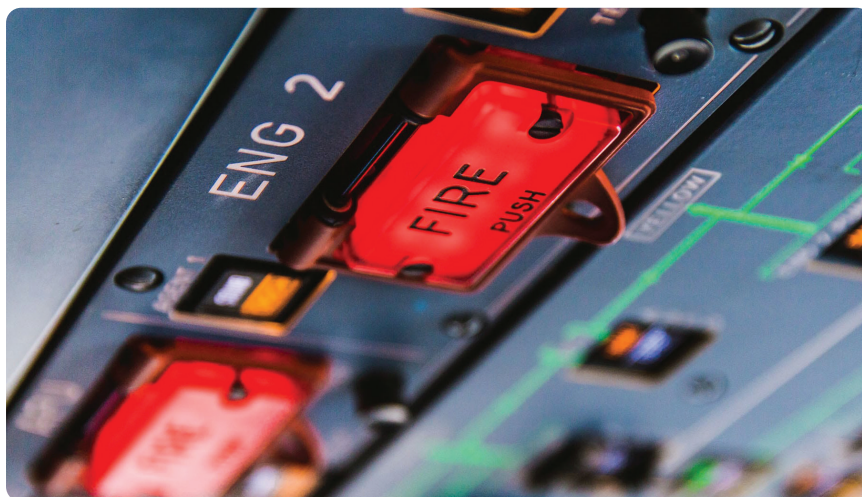
Gambar 4.25 Sakelar Detektor Kebakaran Engine dan APU di Panel Atas Kokpit
