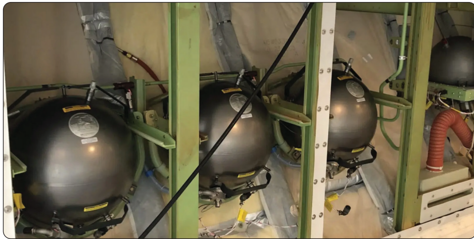
Gambar 4.20 Kontainer Non Portabel (Botol HRD) di Pesawat Angkut Sumber: hrd-aerosystems.com (2022)
