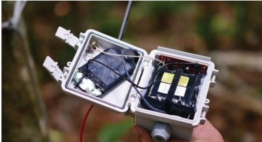
Gambar 3.5 Guardian untuk Mendeteksi Pembalakan Liar di Sumatra Barat Sumber: KKI Warsi/Liputan6.com (2020).
