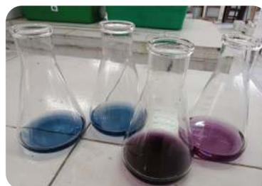
**Gambar 7.9** Perubahan warna indikator EBT pada titrasi kompleksometri
