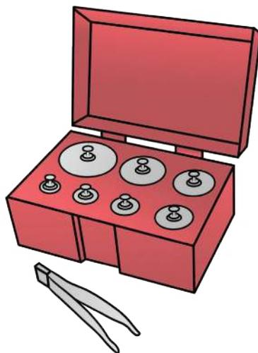
**Gambar 4.12** Contoh set beban (anak timbangan) untuk kalibrasi neraca analitik.
