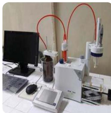
**Gambar 2.6** Digital titrator
