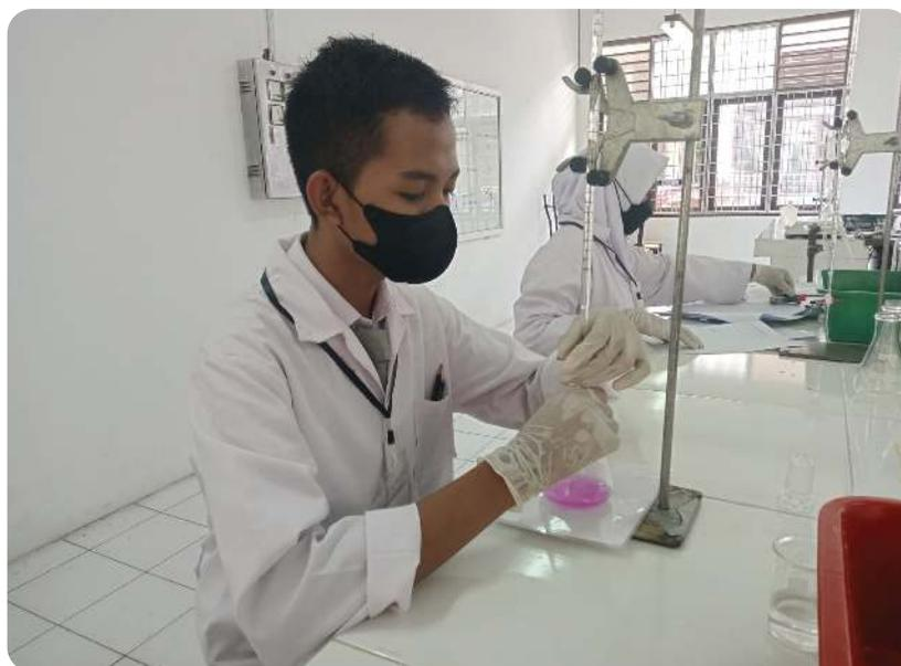
**Gambar 9.20** Titrasi menggunakan indikator phenolphthalein.
