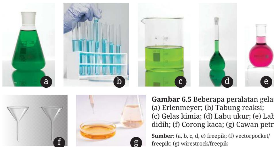
**Gambar 6.5** Beberapa peralatan gelas. (a) Erlenmeyer; (b) Tabung reaksi; (c) Gelas kimia; (d) Labu ukur; (e) Labu didih; (f) Corong kaca; (g) Cawan petri
