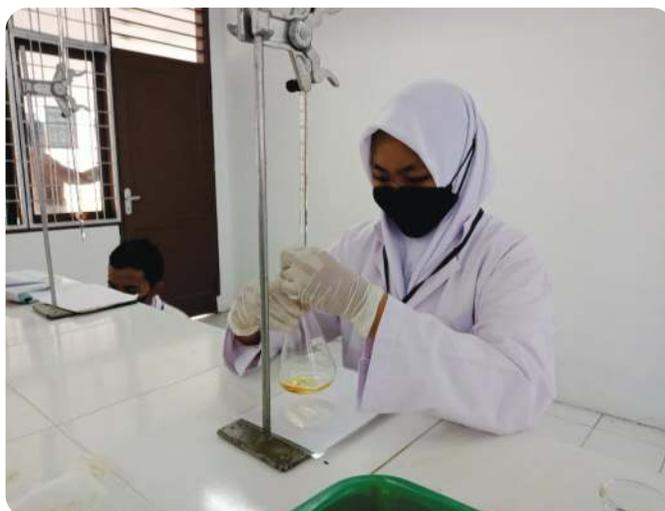
**Gambar 9.19** Titrasi asidimetri
