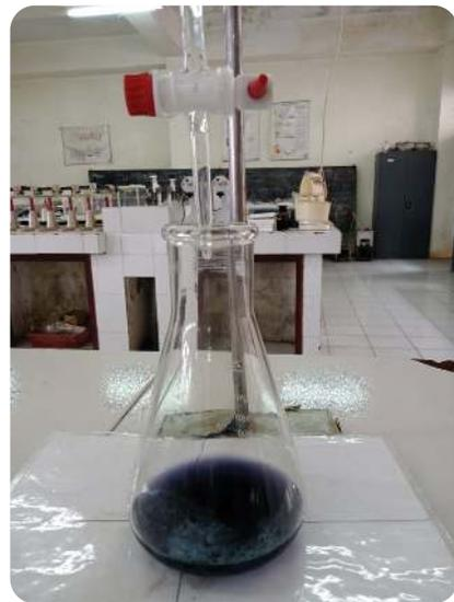
**Gambar 7.7** Titrasi iodometri
