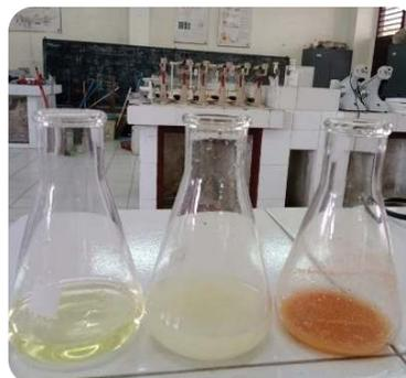
**Gambar 7.8** Perubahan warna indikator pada titrasi
