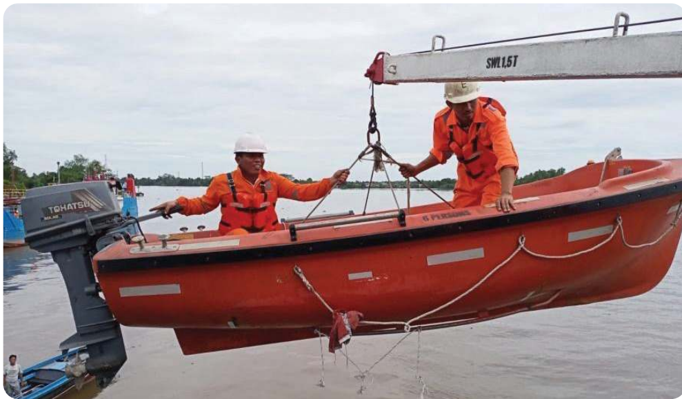
Gambar 5.2 Proses Penurunan Perahu Penyelamat ( Rescue Boat ) Sumber: Budi Setiawan (2022)
