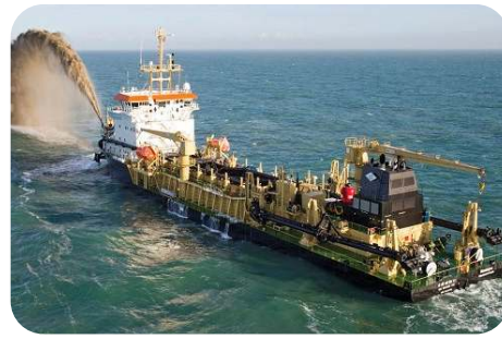
n) Kapal Keruk ( Dredger )
