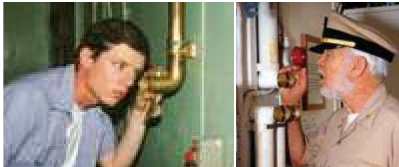
Gambar 4.14 Komunikasi Internal dengan Voice Tube Sumber: National Park Service (2021)
