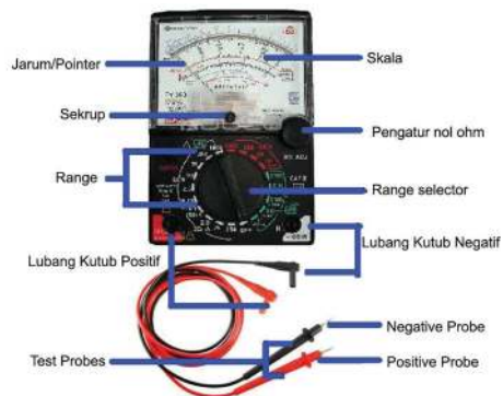
Gambar 8.18 Bagian multimeter analog Sumber : sekolahotomasi.com
