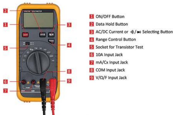
Gambar 8.20 Bagian multimeter digital Sumber: spbukita.com
