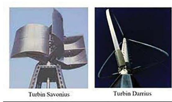
Gambar 7.16 Turbin savonius dan darrieus Sumber: Ambrosio dan Marco (2010)
