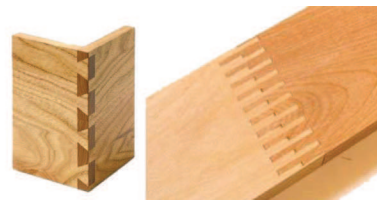
Gambar 2.5 Dovetail and Finger Joint (Sambungan Ekor Burung dan Sambungan Jari-jari)
