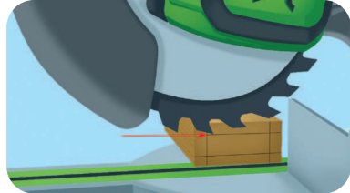
Gambar 2.31 Menggergaji sisi lebar balok kayu.
