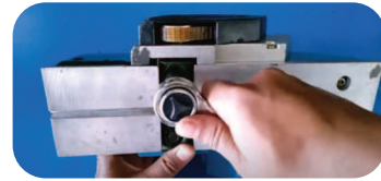
Gambar 3.9 Membuka Baut Pengunci Chisel Sumber: Tangkapan Layar YouTube Channel Seribu (2020)
