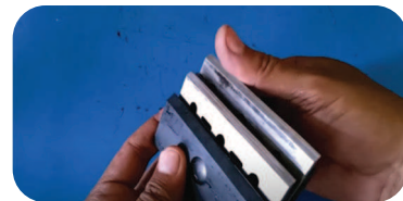
Gambar 3.12 Posisi Chisel Masuk pada Honing Guide
