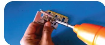
Gambar 3.10 Membuka Sekrup Penyetel Chisel Sumber: Tangkapan Layar YouTube Channel Seribu (2020)
