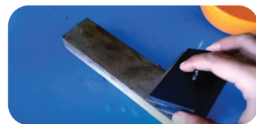
Gambar 3.13 Posisi Penajaman Chisel pada Batu Asah
