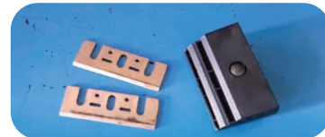
Gambar 3.11 Mata Pisau Chisel dan Honing Guide untuk Menjepit Kedua Pisau Chisel Sumber: Tangkapan Layar YouTube Channel Seribu (2020)
