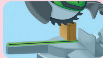
Gambar 2.107 Menggergaji Sisi Tebal Balok Kayu
