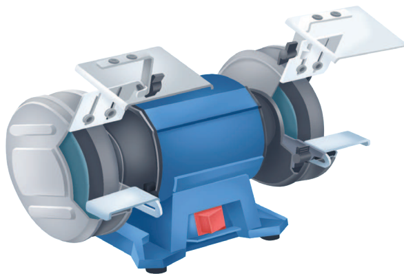
Gambar 3.12 Mesin Gerinda untuk mengasah mata pisau ketam dan pahat.
