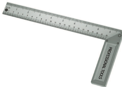
Gambar 3.14 Siku baja untuk memeriksa kesikuan mata ketam.
