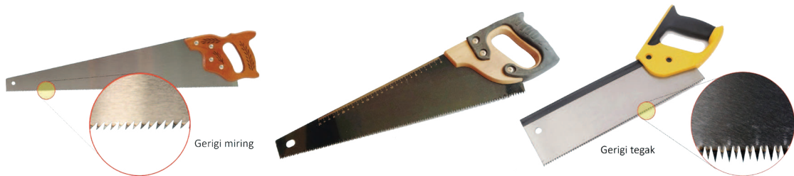
Gambar 3.2 Gergaji Belah (kiri) dan Gergaji Potong (tengah dan kanan)
