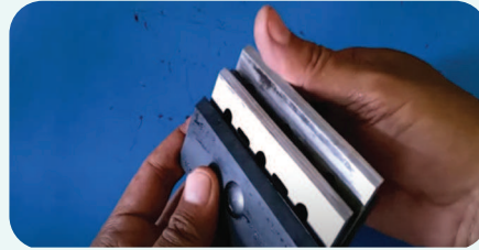
Gambar 3.35 Memeriksa ketajaman chisel dengan ibu jari.
