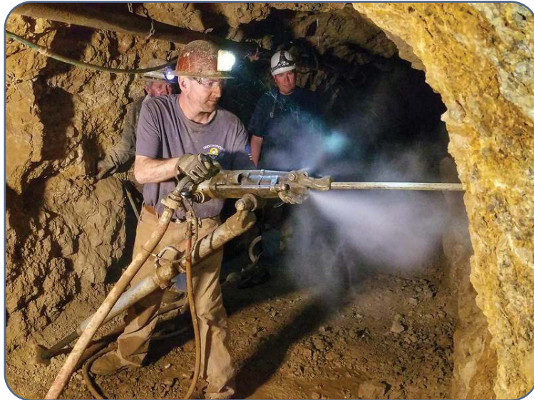
Gambar 7.4 Penggunaan jackleg drill pada tambang bawah tanah.
