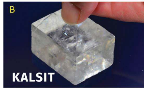
Gambar 4.7 Kuku jari yang memiliki kekerasan 2,5 dapat menggores gipsum yang memiliki kekerasan 2 (A) tetapi tidak dapat menggores kalsit yang memiliki kekerasan 3 (B).
