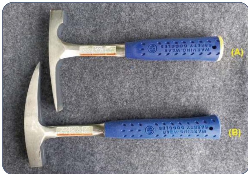
Gambar 5.9 Palu batuan sedimen (A) dan palu batuan beku (B).
