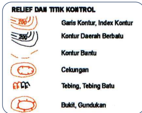
Gambar 6.17 Keterangan garis kontur pada peta rupa bumi. Sumber: Bakosurtanal (2001)
