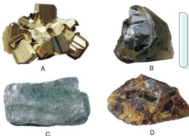
Gambar 4.6 (A) kilap logam pada pirit, (B) kilap kaca pada kuarsa, (C) kilap mutiara pada talk, (D) kilap damar pada sfalerit.
