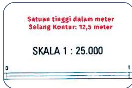
Gambar 6.18 Contoh nilai interval/selang kontur pada peta RBI. Sumber: Bakosurtanal (2001)
