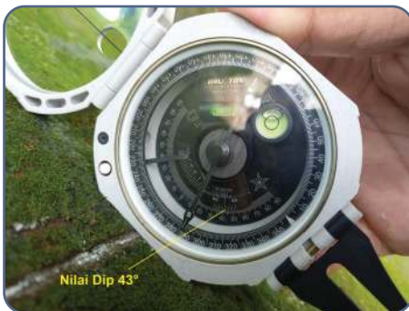
Gambar 5.7 Prosedur kerja mengukur kedudukan lapisan batuan menggunakan kompas geologi (tipe Brunton).
