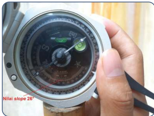
Gambar 5.5 Prosedur kerja pengukuran kemiringan lereng menggunakan kompas geologi (tipe Brunton).
