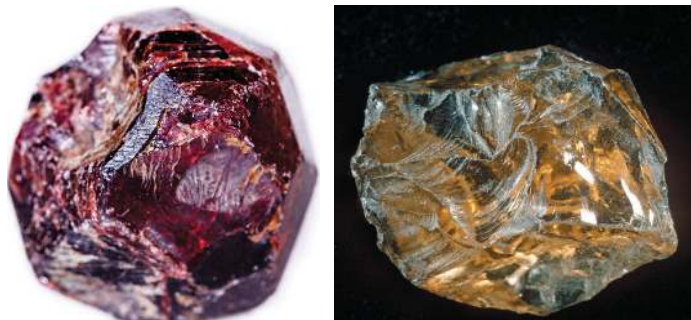
Gambar 4.10 Pecahan tidak beraturan pada mineral garnet (kiri) dan pecahan konkoidal pada mineral kuarsa (kanan).
