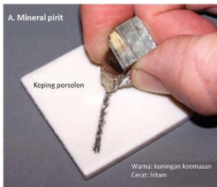
Gambar 4.5 Cerat pada mineral pirit (A) dan mineral hematit (B). Sumber: Busch (2015)
