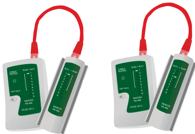
Gambar 5.14 Pengetesan Kabel LAN Straight dan Cross
