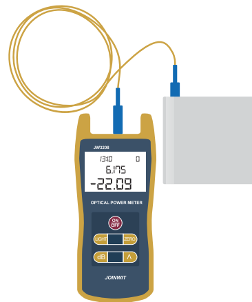
Gambar 5.32 Hasil Pengukuran OPM pada Saluran Online Sumber: Arif Muttakin (2022)
