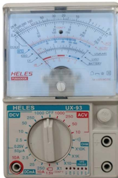
Gambar 5.17 Posisi Jarum pada Nol Meter
