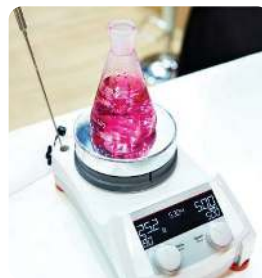
Gambar 4.30 Hot plate yang dilengkapi dengan stirrer .
