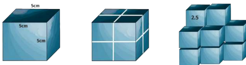
Gambar 8.5 Dengan total volume atau massa yang sama, makin kecil kubus makin besar luas permukaannya.
