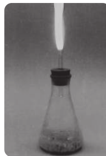
Gambar 6.7 Gas asetilen diperoleh dengan mereaksikan Kalsium karbida dengan air.
