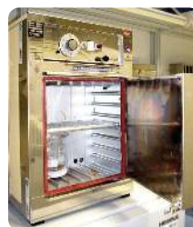
Gambar 4.33 Oven listrik di laboratorium untuk pemanasan dan pengeringan. Sumber: Matylda Sekpl/Wikimedia Commons (2022)
