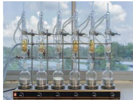
Gambar 1.8 Ekstraktor soxhlet Sumber: Choksawatdikorn/Dreamstime.com (2023)
