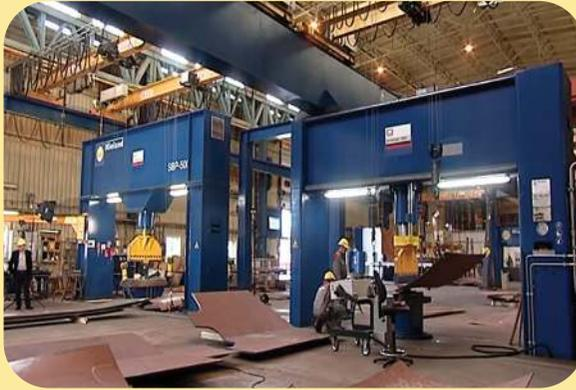
**Gambar 1.32** Proses *Bending* di Bengkel Fabrikasi
