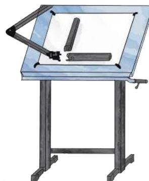
**Gambar 2.7** Mesin Gambar
