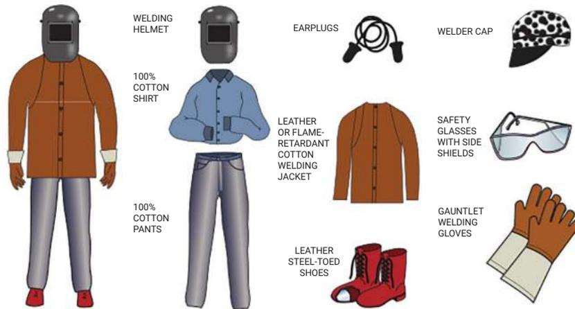
**Gambar 1.27** Alat Pelindung Diri Pekerjaan Pengelasan
