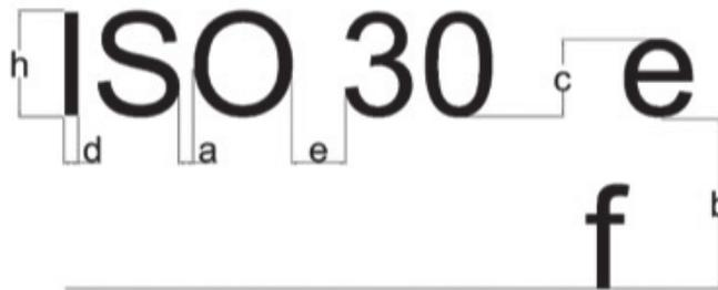
**Gambar 2.13** Penulisan Huruf dan Angka pada Gambar Teknik
