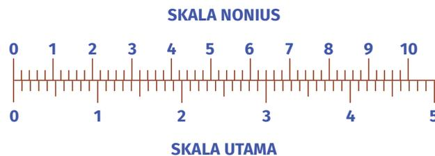
**Gambar 5.3** Skala pada jangka sorong (*vernier caliper*)
