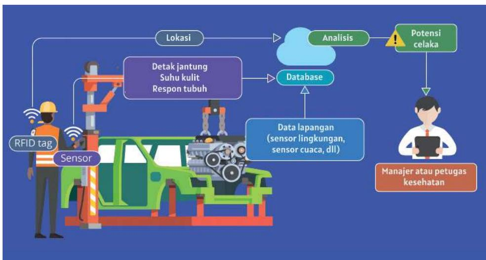
**Gambar 2.7** Infografis IoT untuk kontrol keselamatan di Industri
