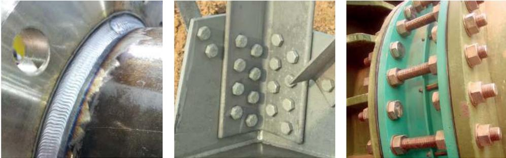
**Gambar 7.1** Sambungan dalam proses manufaktur
