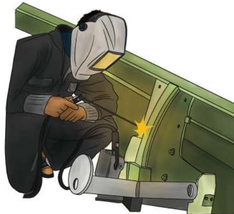
Gambar 3.3 Welder melakukan pemeliharaan dan perbaikan konstruksi kapal
