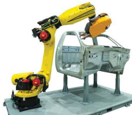
Gambar 2.23 Merakit bodi mobil dengan Spot Welding Robot (FANUC America six-axis R-2000iD/210FH robot) Sumber: Vasilash, 2020
