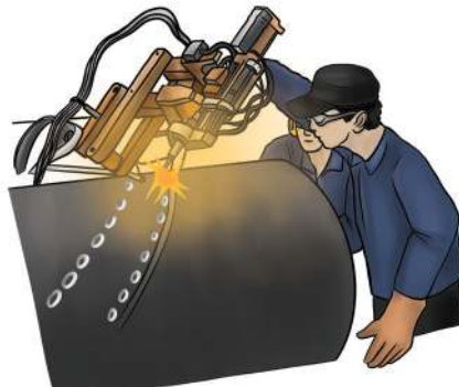
Gambar 3.26 Welding inspector sedang memeriksa hasil proses pekerjaan pengelasan
