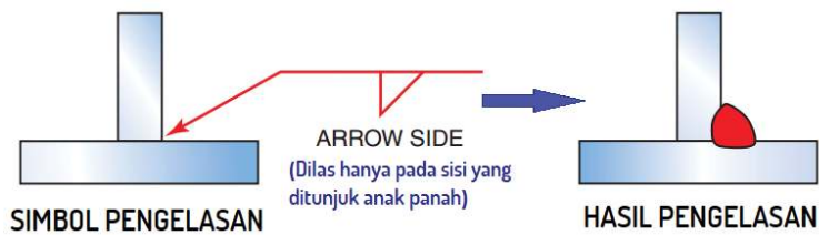
Gambar 6.21 Simbol pengelasan dan hasil pengelasan.
