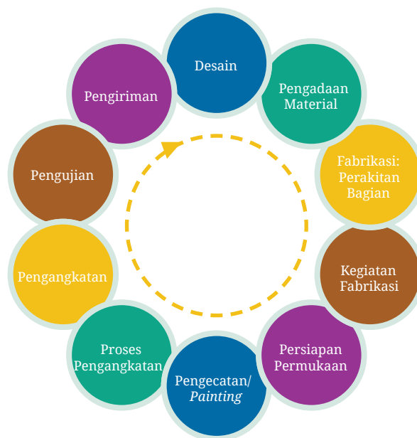
Gambar 1.19 Alur proses perencanaan pembangunan konstruksi kapal.
