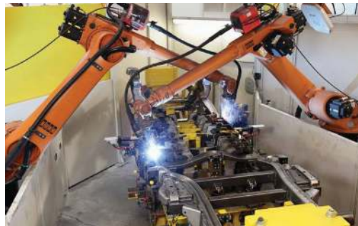
Gambar 2.20 Mengelas badan mobil arah memanjang dan melintang dari ujung depan hingga ujung belakang dengan las robot MIG/MAG.
