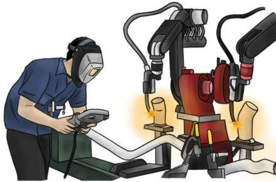
Gambar 3.20 Operator welder sedang melakukan pengawasan pengelasan robot
