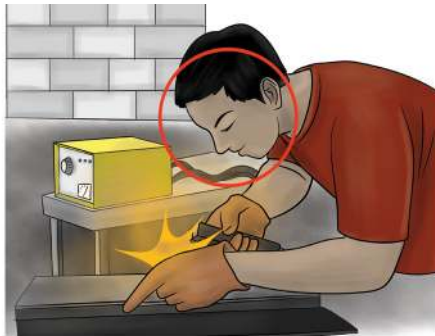
Gambar 4.21 Mengelas tanpa menggunakan kacamata/helm lasa merupakan tindakan tidak aman yang dilakukan oleh welder saat mengelas
