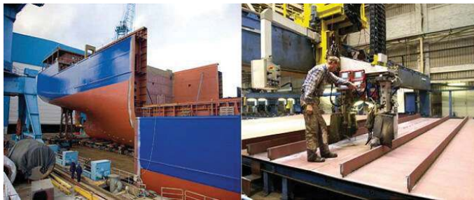
Gambar 2.34 Penggunaan teknologi las otomatis dalam pembuatan rangka kapal
