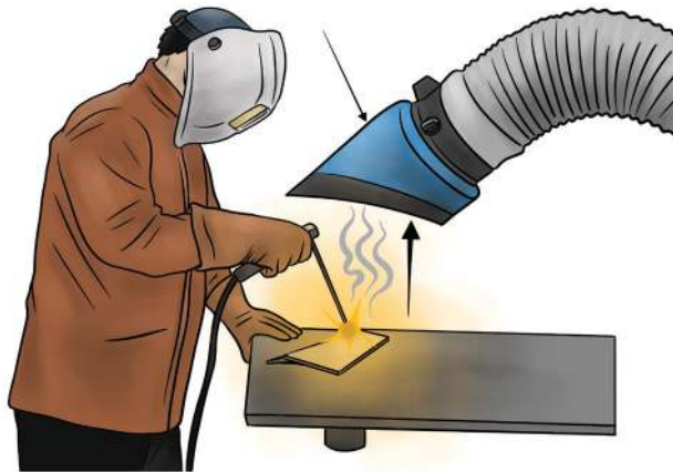
Gambar 4.7 Penggunaan local exhaust ventilation system untuk mengendalikan kontaminan udara yang disebabkan oleh debu di lingkungan kerja.
