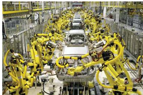
Gambar 2.17 Alur perakitan mobil yang menggunakan teknologi las robot.
