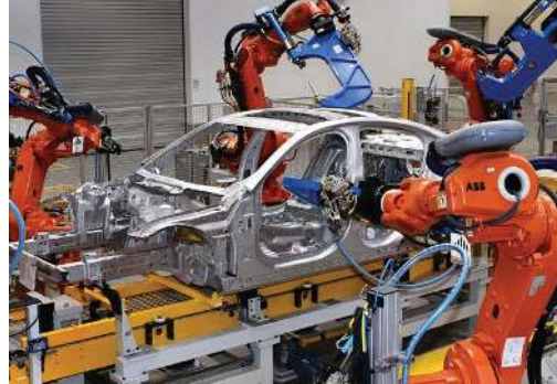
Gambar 2.18 Penggunaan teknologi robot las pada perakitan konstruksi bodi mobil.
