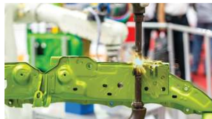
Gambar 2.19 Pengelasan rangka bodi pada perakitan suku cadang mobil dengan Resistance Spot Welding .
