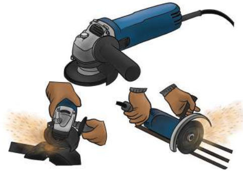
Gambar 5.13 Mesin gerinda tangan dan contoh penggunaannya.
