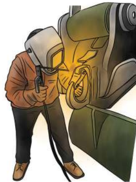
Gambar 3.17 Industrial maintenance welders sedang melakukan perbaikan front end loader bucket pada kendaraan berat wheel loader
