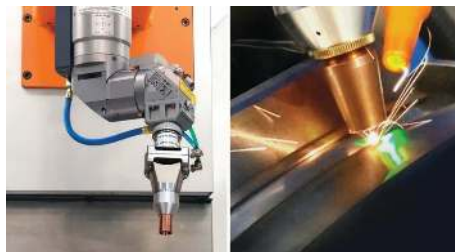
Gambar 2.27 Penggunaan Fiber Laser Welder
