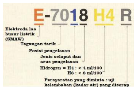
Gambar 5.44 Identifikasi elektroda berdasarkan huruf dan angka.
