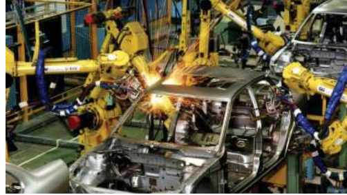
Gambar 2.16 Proses perakitan bodi mobil dengan menggunakan robot las sangat efektif dan efisien.
