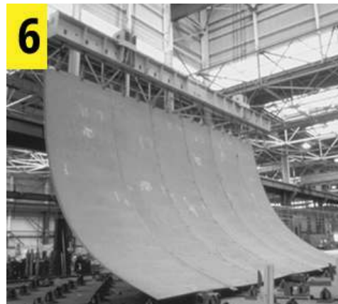
6 Mengelas pelat baja untuk dibuat lambung kapal
