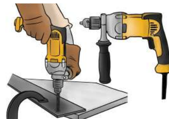
Gambar 5.12 Mesin bor tangan dan contoh penggunaannya.
