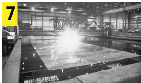
7 Pemotongan pelat baja di dalam air dengan busur plasma
