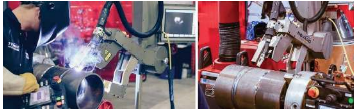
Gambar 2.4 Pengelasan robotik pada konstruksi pipa lebih presisi dan efisien. Sumber: Myers, 2018
