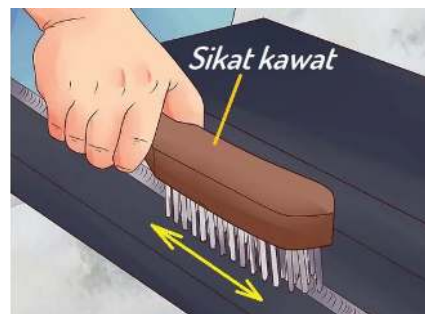
Gambar 7.16 Membersihkan rigi-rigi las hasil pengelasan dengan sikat baja Sumber: Nyoni, 2022
