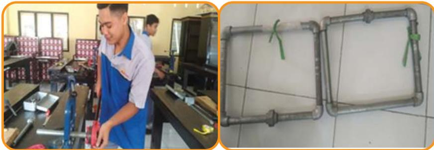
(f) Penyambungan pipa GI (pembuatan ulir) dengan alat *snei*
