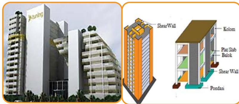
(a) Shear Wall dan Plat Lantai (b) Ilustrasi struktur Shear Wall dan Plat Lantai
