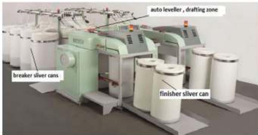
**Gambar 3.13** Mesin *Drawing*
