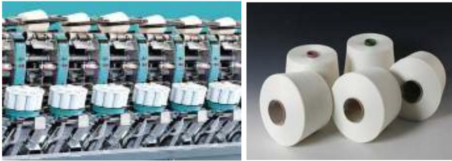
**Gambar 3.17** Proses Penggulungan dan Contoh Produk Akhir Pembuatan Benang
