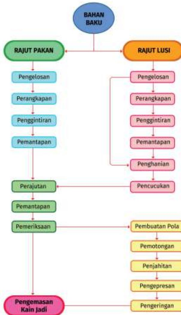
**Gambar 3.33** Urutan Proses Pembuatan Kain Rajut
