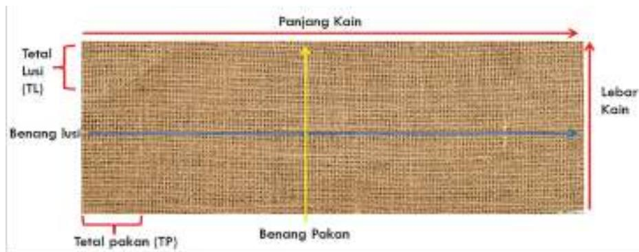
Gambar 6. 13 Konstruksi Kain
