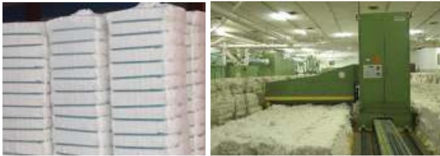
**Gambar 3.10** Bahan Baku Pembuatan Benang Kapas dalam Bentuk Bal Kapas
