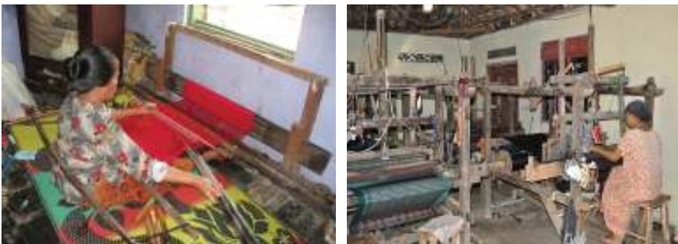
**Gambar 3.29** Alat Tenun Bukan Mesin
