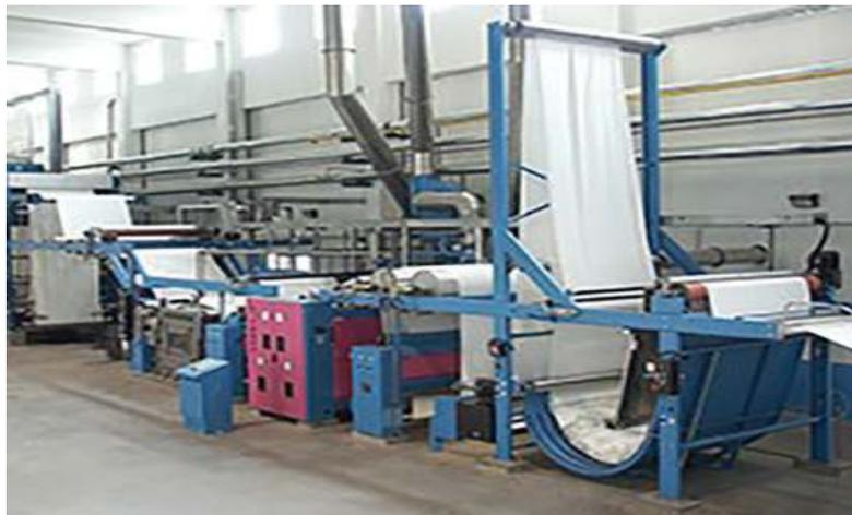
**Gambar 3.38** Mesin Penghilangan Kanji
