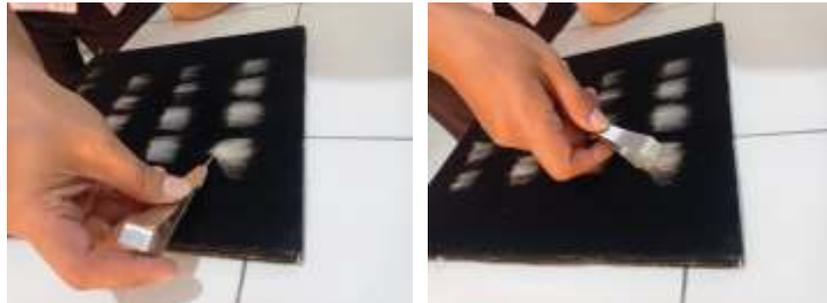
**Gambar 4.33** Proses Pengambilan Fraksi untuk Ditimbang
