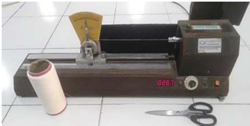
**Gambar 5.14** Alat Pengukur Antihan Benang (*Twist Tester*)
