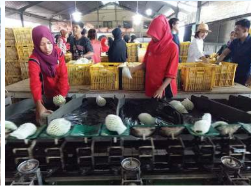
Gambar 4.19 Proses Sortasi dan Grading Semi Modern dengan Menggunakan Sensor Berat Buah Sumber: Evrina SP/Evrinasap (2019)
