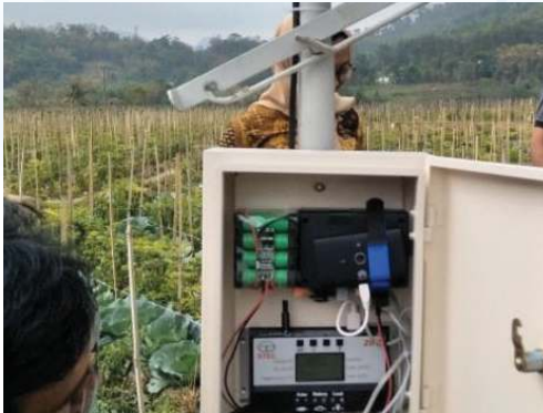
Gambar 2.18 Pemasangan Sensor Tanah dan Cuaca Sumber: Agung/Tabloidsinartani (2019)
