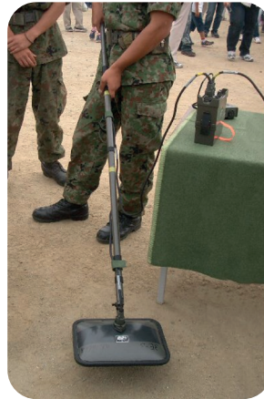
Gambar 4. 25 Pendeteksi logam Sumber : Miya/Wikimedia Commons (2004)
