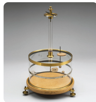
Gambar 4.3 Eksperimen percobaan Coulomb untuk menentukan muatan listrik.
