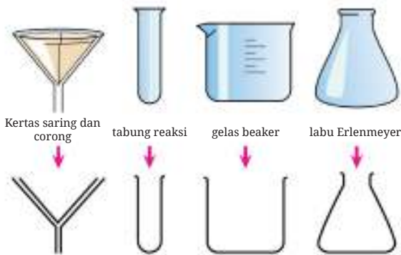
Gambar 1.6 Diagram alat digambarkan dalam bentuk 2-dimensi.
