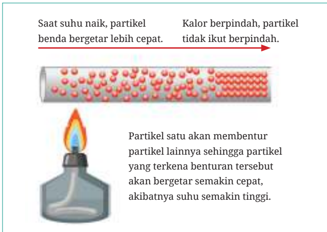
Gambar 3.8 Perpindahan kalor secara konduksi pada logam.
