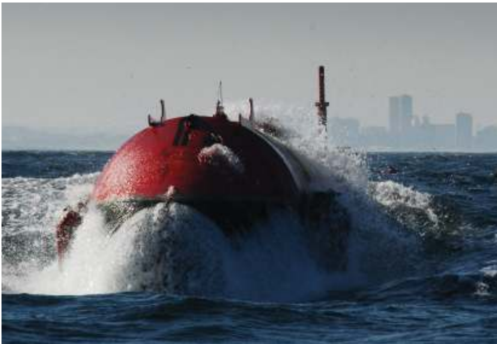
Gambar 3.16 Pembangkit listrik tenaga ombak Pelamis P-750 di Portugal, salah satu sumber energi terbarukan.
