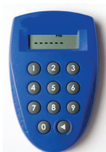
Gambar 8.3. Key generator salah satu bank swasta.
