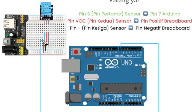
Gambar 9.24 Pin DHT11 yang dipasang ke Arduino
