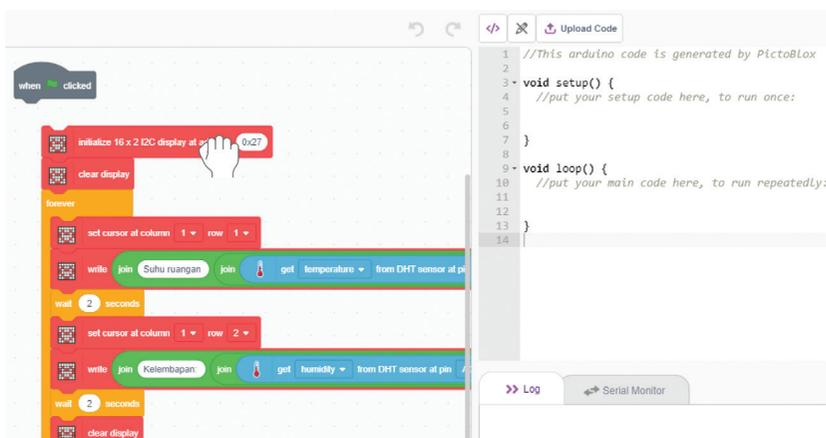
3. Ganti blok when
