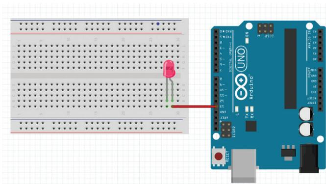
3. Sambungkan pula dengan kabel *jumper* sisi negatif LED, kemudian sisinya lagi sambungkan ke GND (*Ground*).
