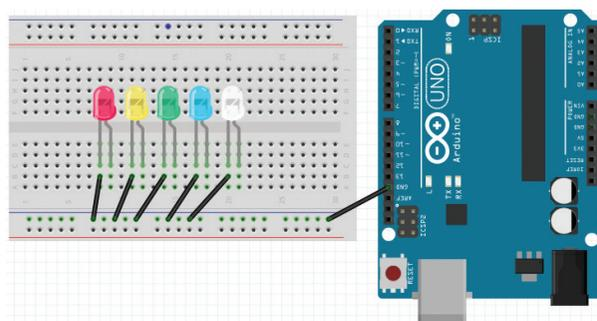
3. Pasangkan kabel *jumper* ke semua sisi positif LED, kemudian sisi satunya sambungkan ke bagian pin digital Arduino Uno masing-masing pin 9,10,11,12 dan 13. Dari pin 9-13, pastikan warnanya berurutan seperti berikut:
