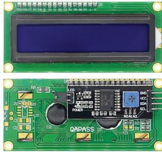
Gambar 9.22 Modul I2C yang dipasang pada LCD
