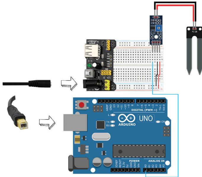
Penggunaan sensor kelembapan tanah ini sebenarnya sangat sederhana. Tancapkan sensor pada tanah dan sensor akan mengambil data tentang kelembapan tanah dan setelah itu, data akan dikirimkan pada Arduino.
