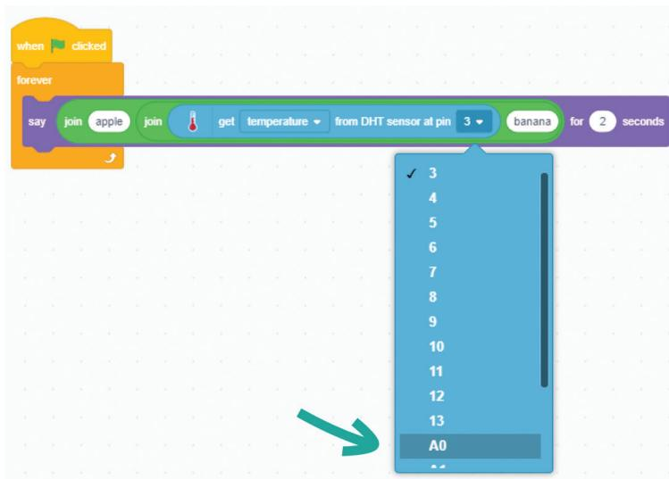
Gambar 9.34 Angka pin yang dipilih sesuai pin Arduino
