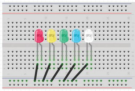
2. Kemudian, pasang kabel *jumper* di sisi negatif *breadboard*, lalu sambungkan ke GND (*Ground*) pada Arduino Uno.
