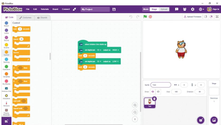
8) Upload blok program tersebut ke Arduino Uno dengan klik upload di bagian kanan atas.
