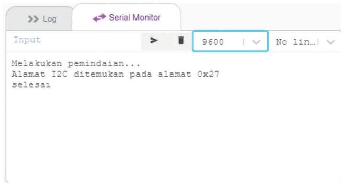
Gambar 9.43 Melihat alamat I2C pada Serial Monitor
