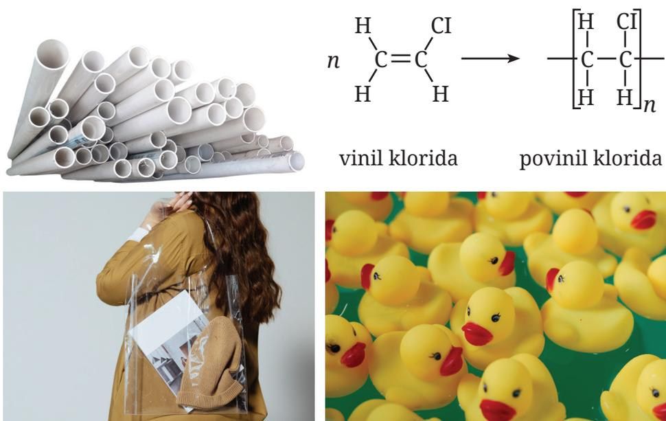
**Gambar 4.11** Struktur monomer vinil klorida dan polimer PVC serta contoh benda-benda yang terbuat dari PVC
