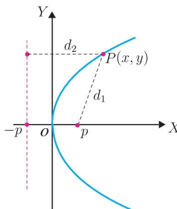
Gambar 1.24. Grafik Parabola Dengan Puncak  $O(0,0)$  dan Sumbu Simetrisnya adalah Sumbu  $X$
