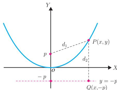
Gambar 1.23. Kurva Parabola Dengan Sumbu Simetris adalah Sumbu  $Y$
