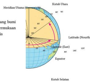
Pada gambar samping, ditunjukkan bahwa adalah memungkinkan untuk menentukan garis lintang dari titik A ( $\angle AOC$ ) menggunakan garis lintang dari Polaris ( $\angle DAB$ ).
