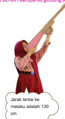
Mengukur sudut ketika melihat ke atas dan jarak tempat berdiri sampai ke gedung sekolah, lalu membuat gambar perkecilan.
