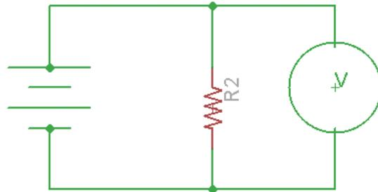
Gambar 6.25 Skema Pengukuran Tegangan dengan Voltmeter
