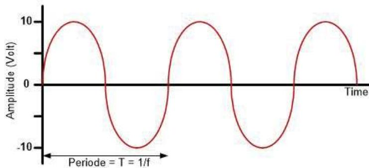
Gambar 4.9 Gelombang Sinusoidal
