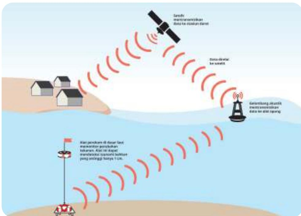
Gambar 2.11 Pendeteksian Tsunami
