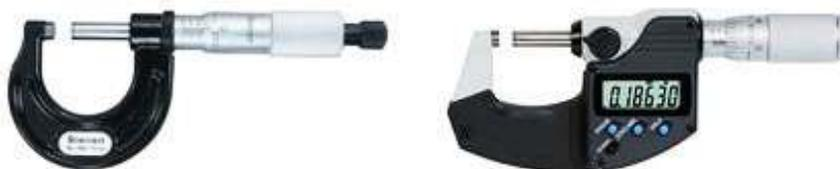
Gambar 6.3 Mikrometer Sekrup
