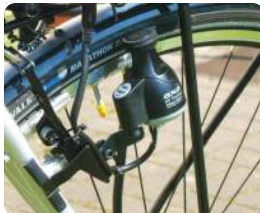
Gambar 4.16 Contoh Generator DC yang Digunakan Sebagai Dinamo Sepeda
