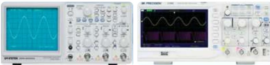
Gambar 6.7 Osiloskop Analog dan Digital
