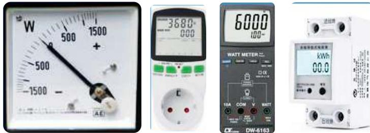
Gambar 6.6 Wattmeter Analog dan Digital
