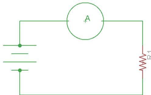
Gambar 6.26 Skema Pengukuran Arus dengan Amperemeter
