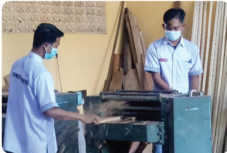
Gambar 5.1 Mengoperasikan Mesin Ketam Ketebalan
