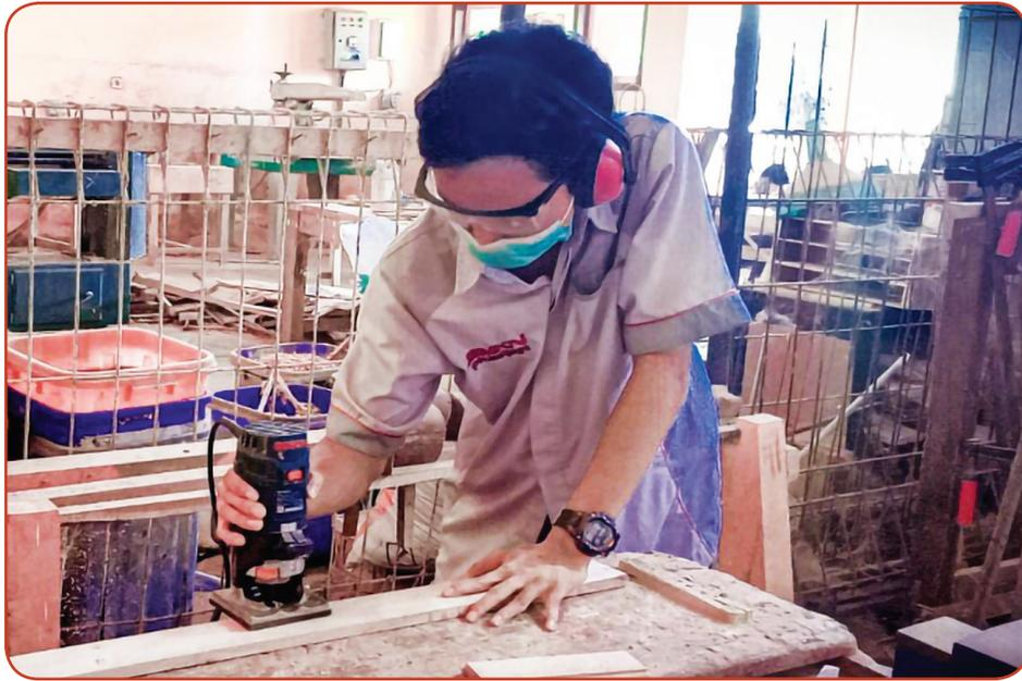
Gambar 3.1 Siswa sedang menggunakan “mesin tangan profil kayu” (*wood trimmer machine*).
