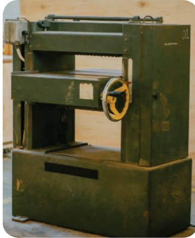
Gambar 4.50 Mesin Ketam Ketebalan
