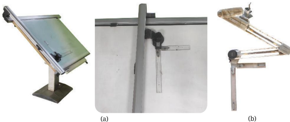
Gambar 6.13 Mesin Gambar Rol (a) dan Mesin Gambar Lengan (b)
