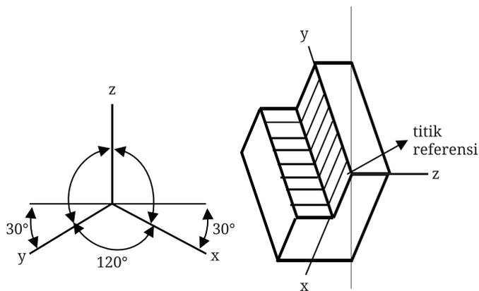
Gambar 6.49 Proyeksi Isometri dengan Posisi Horizontal
