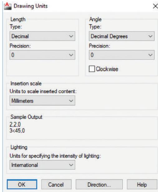
Gambar 6.56 Kotak Dialog *Drawing Unit*
