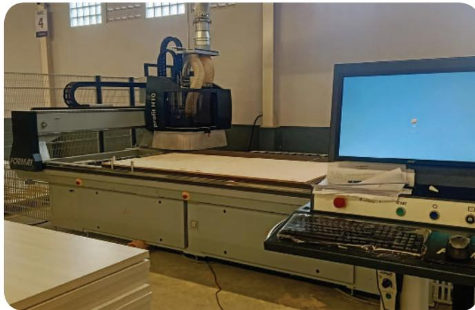
Gambar 3.9 Mesin CNC Router
