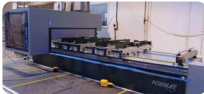
Gambar 3.8 Mesin *Frais* atau *Milling* CNC
