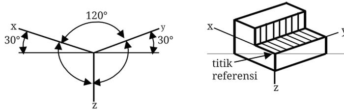
Gambar 6.47 Proyeksi Isometri dengan Posisi Normal
