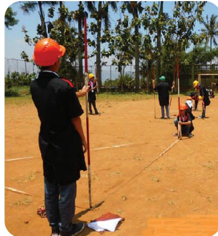
**Gambar 5.14** Pengukuran Menggunakan Yalon
