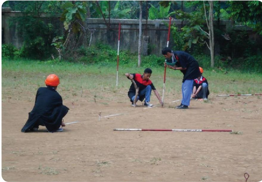
**Gambar 5.3** Pengukuran Jarak Menggunakan Pita Ukur
