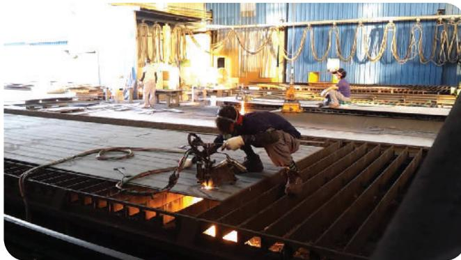
Gambar 2.5 Pemotongan Material dengan Semi Otomatis (*Hand Auto*)
