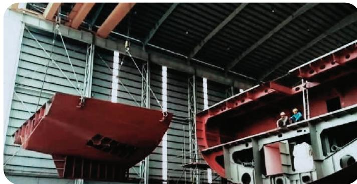
Gambar 2.1 Pembangunan Kapal Sistem Blok
